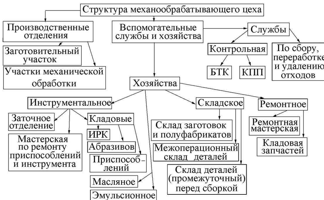
Рис. 6. Структура цеха механической обработки деталей
