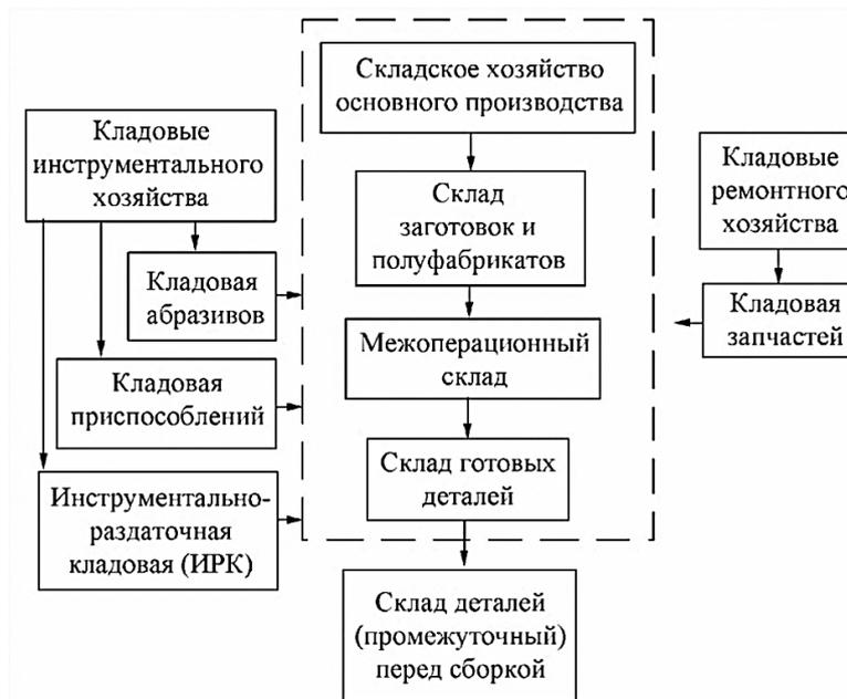
**Рис. 17. Граф-структура складов и кладовых обрабатывающего производства**
