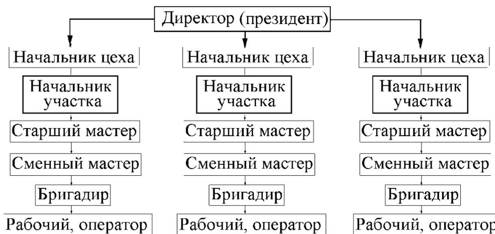
**Рис. 37. Схема линейной организационной структуры управления**
